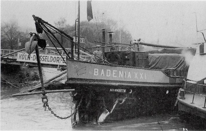
Dampfschiff "BadeniaXXI", Kapitän Heinrich Schneider, Nackenheim, nach Zusammenstoß mit Raddampfer im Nebel vor Oberwesel. Der Ankerraum wurde eingedrückt. Die Zwischenschotten schützen Lade- und Schiffsräume vor Wassereinbruch. Dadurch besteht keine Gefahr, dass das Schiff sinkt.
